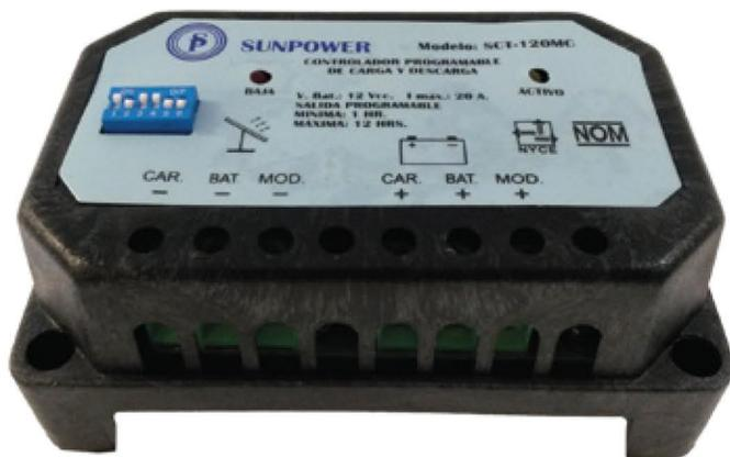
El tempocontrolador solar protege a las baterías contra daños de cargas y descargas profundas en sistemas solares de 12 y 24Vcc con una capacidad de 20 y 30A, se programa desde 1 hasta 12 horas. El tempocontrolador censa permanentemente el voltaje de panel, cuando tiene un voltaje equivalente al de las 19:00 hrs de horario de invierno, enciende la lámpara iniciando la programación de tiempo establecida.
