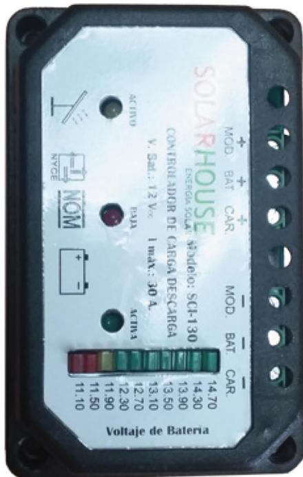
Controlador solar protege a las baterías contra daños de cargas y descargas profundas en sistemas solares de 12 y 24Vcc con una capacidad de 20 y 30A, está diseñado para aprovechar al máximo la vida de las baterías y cuenta con indicadores de estado del panel y de batería por medio de una barra de 10 leds.
